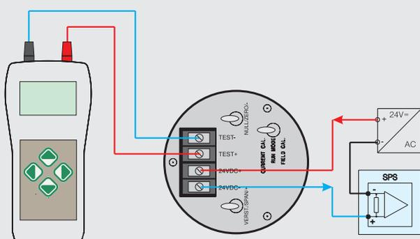
Многофункциональное измерительное устройство 4...20 мА 2-х проводной шлейф
